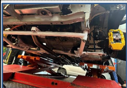
照片 4 說明：本學年度打造的鋼骨底盤結構
