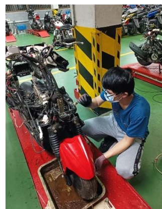
照片 3 說明：前蝶煞車更換
