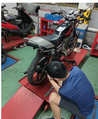
照片 2 說明：檔車野狼鍊條拆裝
