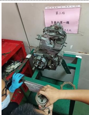
照片 5 說明：離合器片分解
