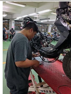
照片 6 說明：排氣管拆裝
