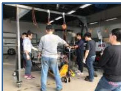
照片 2 說明：團隊自製引擎調架，移植複合動力系統之過程
