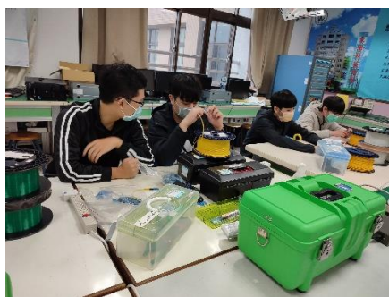
照片 2 說明：光纖接續與 OTDR 操作檢測
