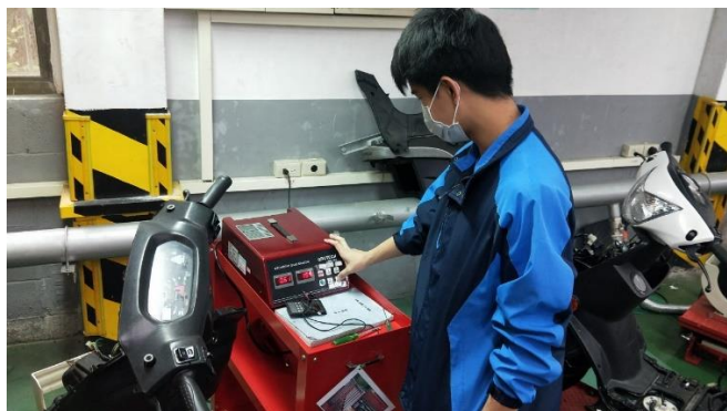
照片說明：實作拆裝(操作廢棄分析儀)-2
