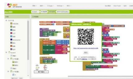
規劃手機程式畫面規劃，從左方元件庫拉入所需的原件，由右方設定屬性。
