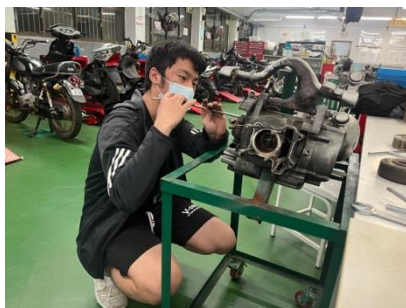
照片 2 說明：變速箱拆解
