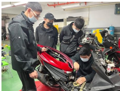
照片 5 說明：燃油泵浦更換
