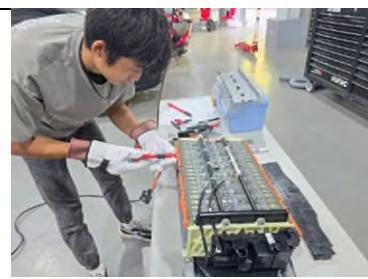
圖 5 說明：HV 電迴路量測實務體驗
