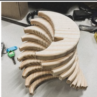
運用 CNC 進行細部雕刻、挖槽與輪廓切割
