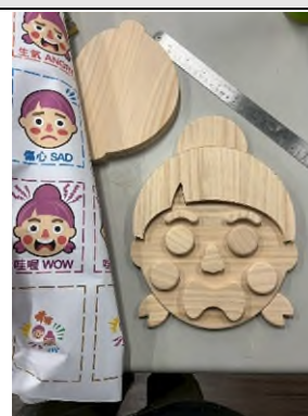
運用 CNC 進行細部雕刻、挖槽與輪廓切割
