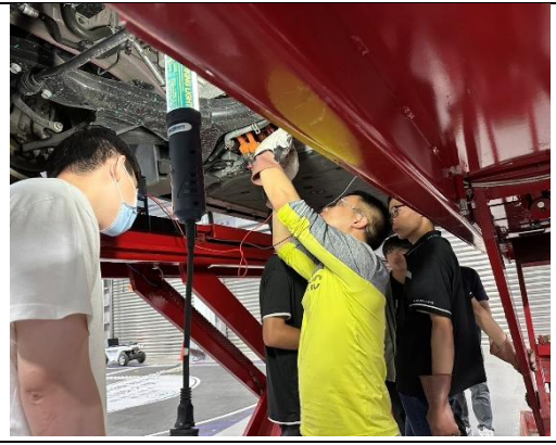
圖 6 說明：HV 電池車上量測實務體驗
